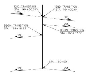
**SUPERELEVATION DATA CROSS SLOPE**
